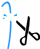
3. 剪去料丝弯曲部分以免堵塞。
